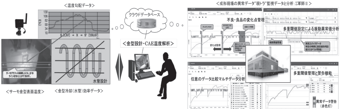
第5図 サーモモニタリンとΣ軍師IIの成形現場センシングデータとCAE・金型設計との連携システム
